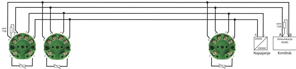
Več merilnih pretvornikov lahko povežemo v komunikacijsko mrežo. Pri tem uporabimo 2 - parični kabel: po eni parici poteka komunikacija Rs485 (modbus protokol) po druga pa napajanje. Pri večjih razdaljah in več merilnih pretvornikih v mreži, moramo začetek in konec kominikacijske mreže zaključiti z uporoma 120E.
