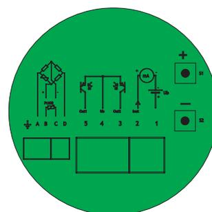
Čelna plošča za merilnik temperature MT 201 - verzija z dvema izhodnima limitnima paroma (dve LED diodi se vklopita ob vklopu limitnih parov-zunanja releja).
