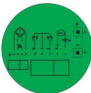
Čelna plošča za merilnik temperature MT 211 (merilnik nima izhodnih limitnih parov).
