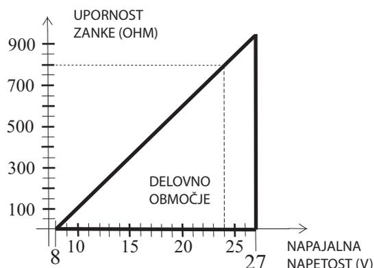
Iz enačbe vidimo, da je skupna najvišja upornost v tokovni zanki do 800 Ohm (pri napajalni napetosti 24V). Če prekoračimo najvišjo dovoljeno upornost v tokovni zanki, se zelo poveča merilna napaka. V primerih, ko želimo višjo Ohmsko obremenitev tokovne zanke, uporabimo merilni pretvornik 4-20mA/4-20mA.
