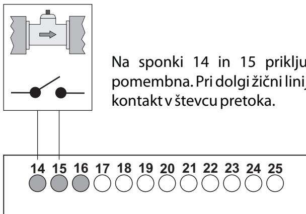
Na sponki 14 in 15 priključimo reed kontakt števca pretoka. Polariteta ni pomembna. Pri dolgi žični liniji je potrebno zaščititi elektroniko pretvornika in reed kontakt v števcu pretoka.
